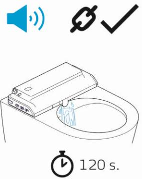
**ES** Desde el instante en que se enchufa el aparato a la red (2), se dispone de 60 segundos para sincronizar el mando. Para sincronizar el mando (3), presionar simultáneamente los botones Secado y Paro/Stop del mando durante 5 segundos hasta que se escuche un beep y se enciendan todos los LED del mando. A partir de ese momento se inicia un proceso de auto-calibración del aparato (4) que dura 120 segundos, durante el cual sale agua por la ventana de la cánula del e-bidet.
